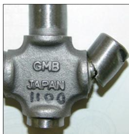
破壊強度が正規品の半
