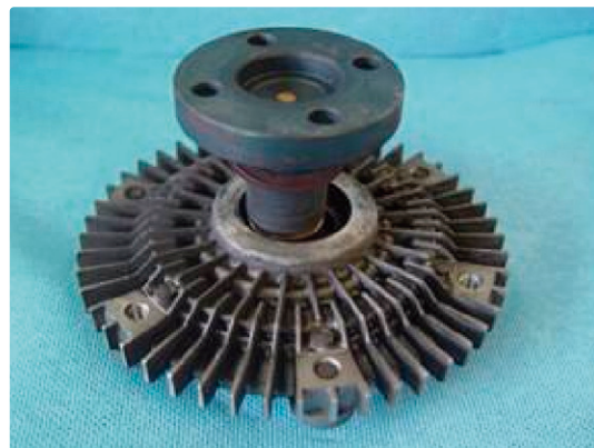
Bloqueo y rotura del rodamiento del embrague del ventilador
