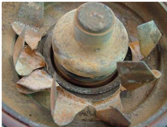
Corrosión del impulsor
