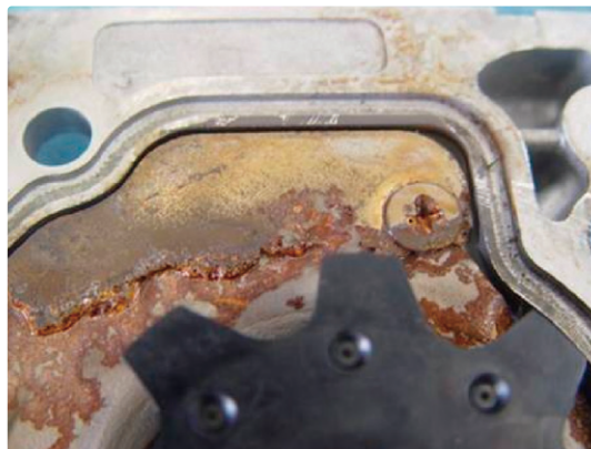
Corrosión de la placa inferior
